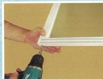
Скрепить створку и направляющие профили саморезами
