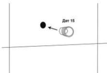
8. Вкладываем прокладки в угловое соединение и вворачиваем в полотенцесушитель.
