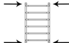
5. Закручиваем краны Маевского в свои гнезда. Проверяем, закрыты ли сами краны Маевского.
