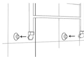
18. Протягиваем все соединения специальным инструментом (разводным ключом).
