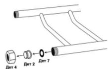
4. Надеваем кольцо на переходник, вкручиваем в кольцо шпильку, затягиваем отверткой. Повторяем ту же операцию с противоположной стороной.
