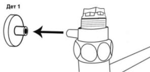
23. Закрываем клапан крана Маевского
