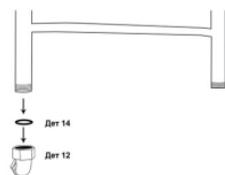
15. В гайку угловое соединение вкладываем прокладки.
