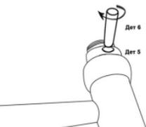
11. Производим сверление технологических отверстий
