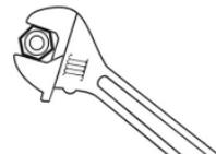
3. Берем один из переходников, надеваем гайку, вкладываем прокладку. Устанавливаем его в верхней части полотенцесушителя при помощи разводного ключа. Повторяем те же действия с другой стороны. Переходник под кран Маевского закручиваем не сильно, чтобы не повредить резиновые уплотнители.
