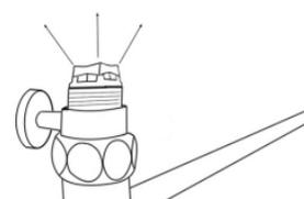
7. На эксцентрики подматываем сантехническую нить (в комплект не входит) и вворачиваем в подводу центральной системы отопления или водоснабжения с необходимым количеством витков
