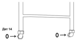
16. Берем полотенцесушитель вставляем шпильки в держатели и затягиваем шестигранным ключом стопорные винты в держателях
