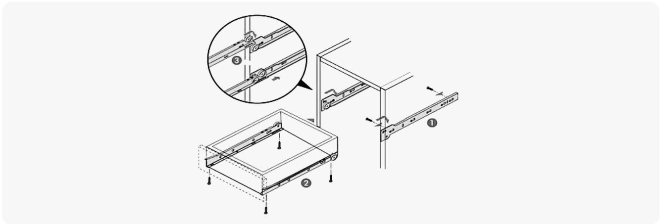
Регулировка роликовых направляющих
