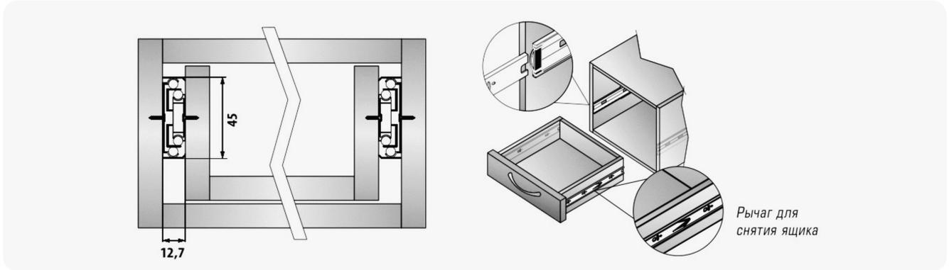
Регулировка шариковых направляющих
