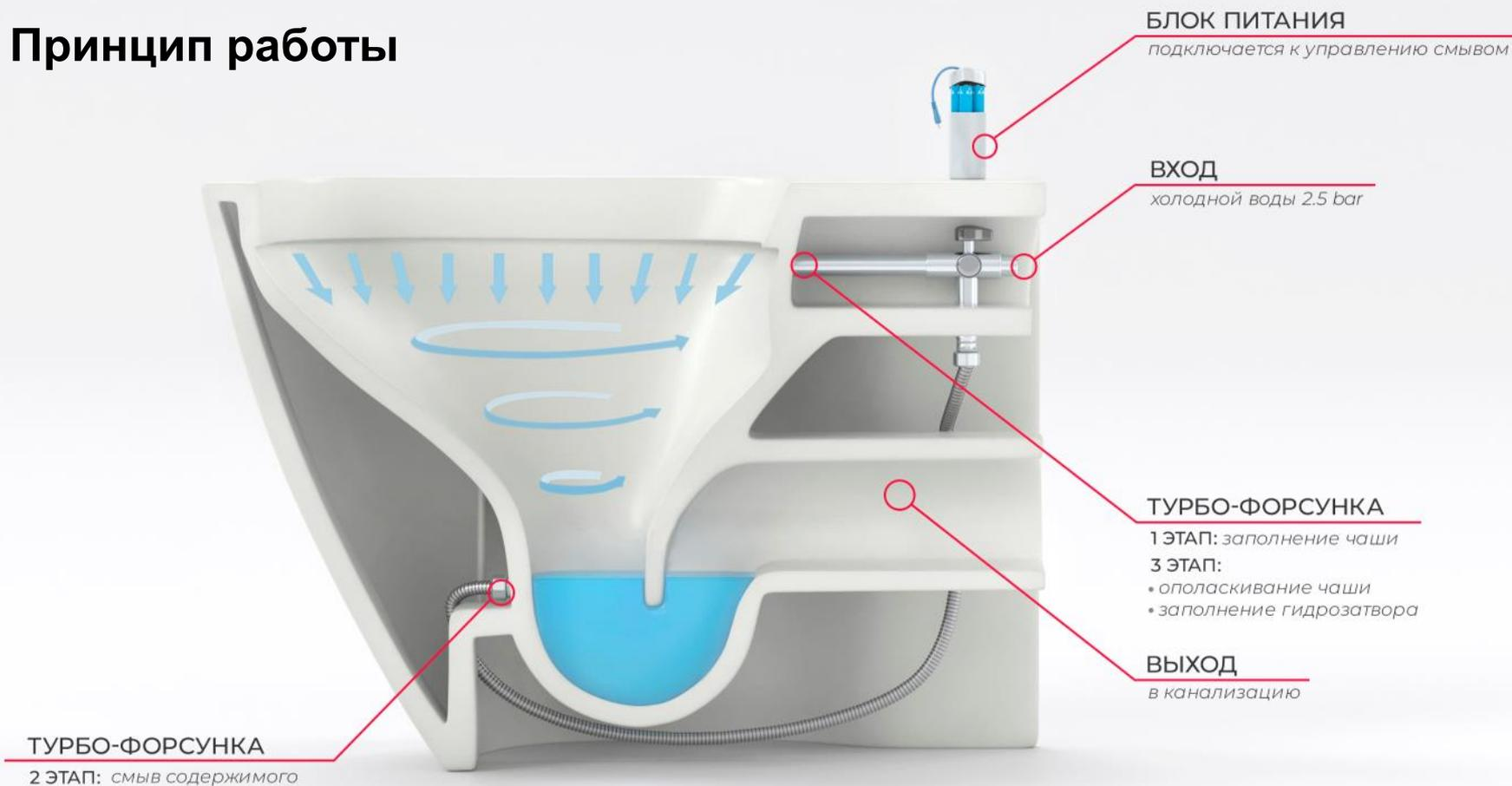
Унитаз подключается напрямую к системе водоснабжения, внутри встроен механизм, работающий на стандартных батарейках.
