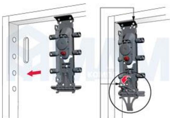
Рекомендуется дополнительная фиксация на саморезы 3,5×20 мм
