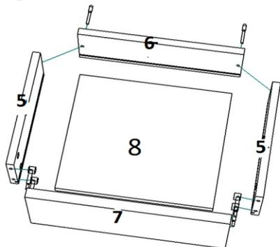
Еврошурупами скрепить детали 5 и 6, в пропил вставить ЛДВП. В готовые отверстия детали 7 ввернуть эксцентрики и закрепить фасад на корпус ящика стянув замками. К нижней части ящика привернуть шурупами 3,5\*16 направляющие колесом назад. Вкатить ящик в корпус тумбы.
