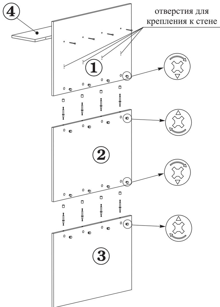
1. В отверстия на вертикальных панелях (дет.№№1,2,3) вставьте эксцентрики. **Обратите внимание: стрелка на эксцентрике должна быть направлена к торцу детали.**
