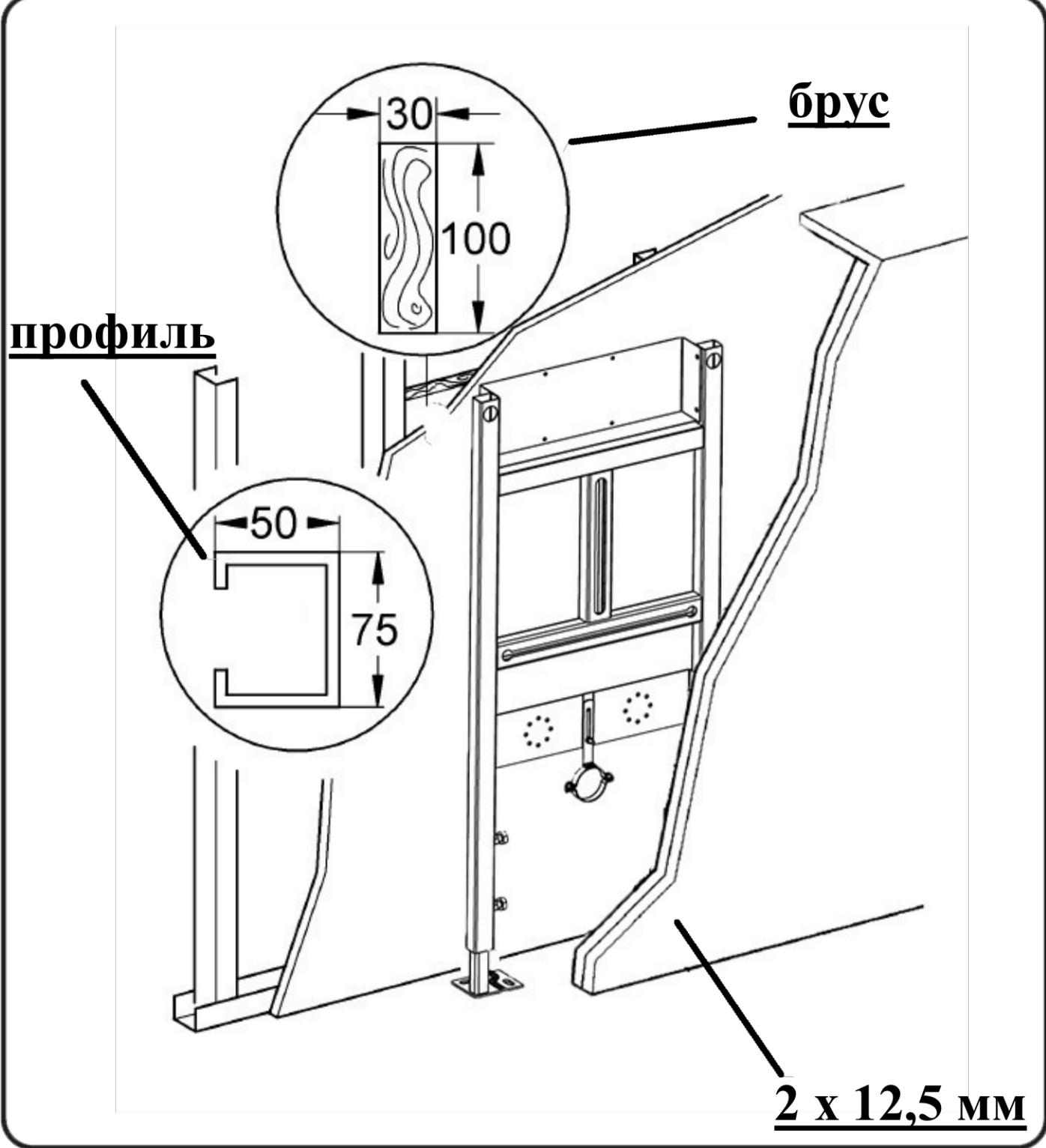
При монтаже инсталляции без стены. Необходимо использовать металлический профиль размером не менее 75x50 мм и деревянный брус размером не менее 100x30 мм. Далее обшить инсталляцию двумя листами гипсокартона 12,5 мм перед укладкой настенной плитки.
