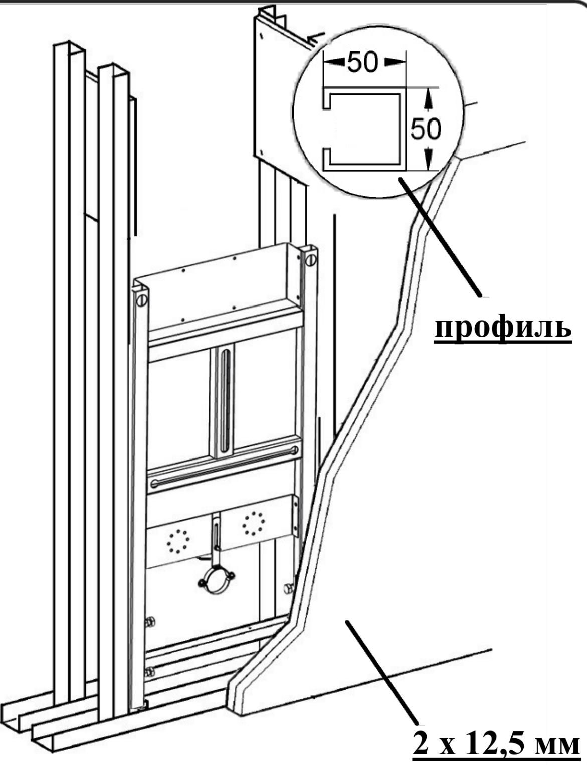
При монтаже инсталляции не к капитальной стене, то необходимо использовать металлический профиль размером не менее 50x50 мм. Далее обшить инсталляцию двумя листами гипсокартона 12,5 мм перед укладкой настенной плитки.
