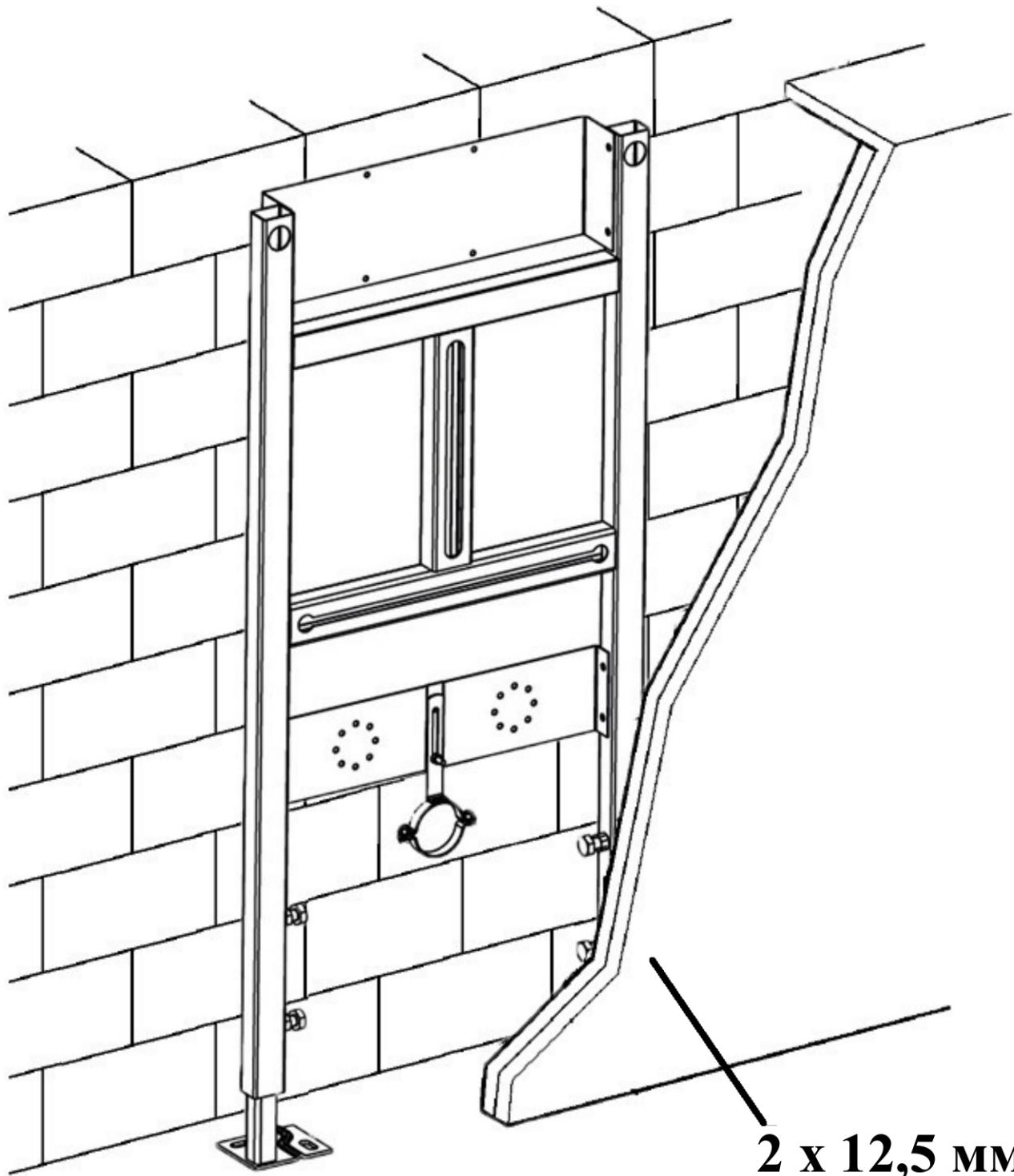
Проверьте несущую способность стены. При монтаже инсталляции к капитальной стене, необходимо обшить инсталляцию двумя листами гипсокартона 12,5 мм перед укладкой настенной плитки.
