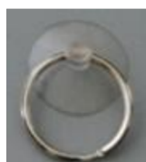
Присоска для снятия внутренней части сенсорной панели
