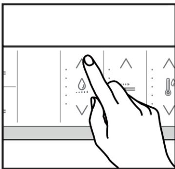
При активной функции «Биде» нажмите  $\wedge$ , чтобы увеличить интенсивность потока воды; нажмите  $\vee$ , чтобы уменьшить напор воды.
