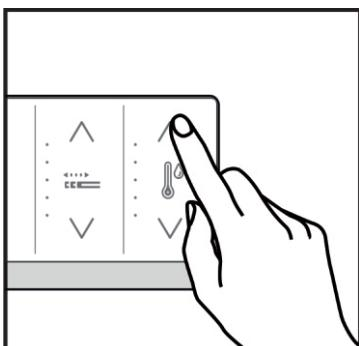
При активной функции «Биде» нажмите  $\wedge$ , чтобы увеличить температуру воды; нажмите  $\vee$ , чтобы снизить температуру воды.
