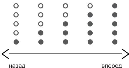
При нажатии на  $\wedge$  форсунка выдвигается вперед. Каждый раз при нажатии на  $\wedge$  положение форсунки меняется на 1 уровень до тех пор, пока не будет достигнут наивысший уровень. При нажатии на  $\vee$  форсунка втягивается назад. И каждый раз при нажатии на  $\vee$  положение форсунки меняется на 1 уровень до тех пор, пока не будет достигнут наименьший уровень.
