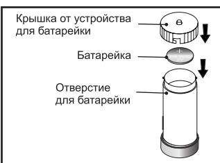
б. Откройте крышку устройства для батарейки и вставьте подходящую батарейку + CR 2032 3V, соблюдая верное положение, как показано на рисунке выше.
