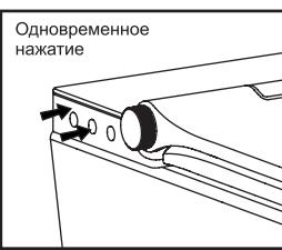
а. Одновременно нажмите кнопки "Вкл/Выкл" и "Обмыв". После этого вы услышите длинный звуковой сигнал, что означает, что устройство готово к перезагрузке. Если звуковой сигнал не последовал, значит, нажатие кнопок было не одновременным и необходимо снова повторить операцию.
