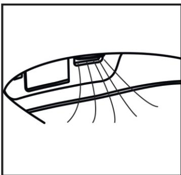
При активной функции «Сушка» открывается специальное отверстие, из которого исходит поток комфорtnого теплого воздуха.
