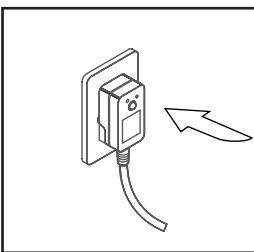
б. Подключите питание устройства, загорится световой индикатор, в течение 15 секунд будет происходить загрузка. После звукового сигнала и погаснувшего светового индикатора загрузка будет завершена.
