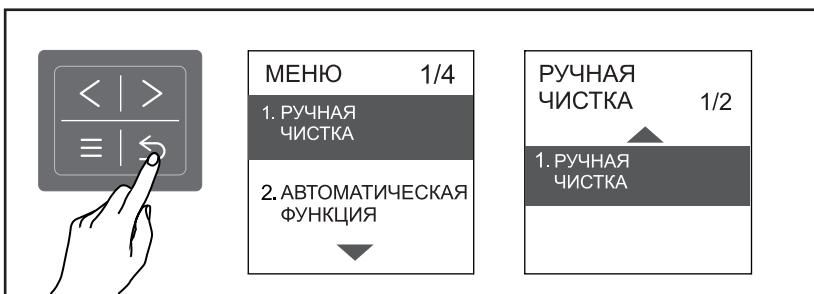
2. Активируйте очистку форсунок в соответствии с описанной выше операцией на задней панели пульта дистанционного управления. Форсунка выдвинется без пульсирующей струи воды. Устройство будет издавать короткий звуковой сигнал каждые 3 секунды во время процесса очистки.
