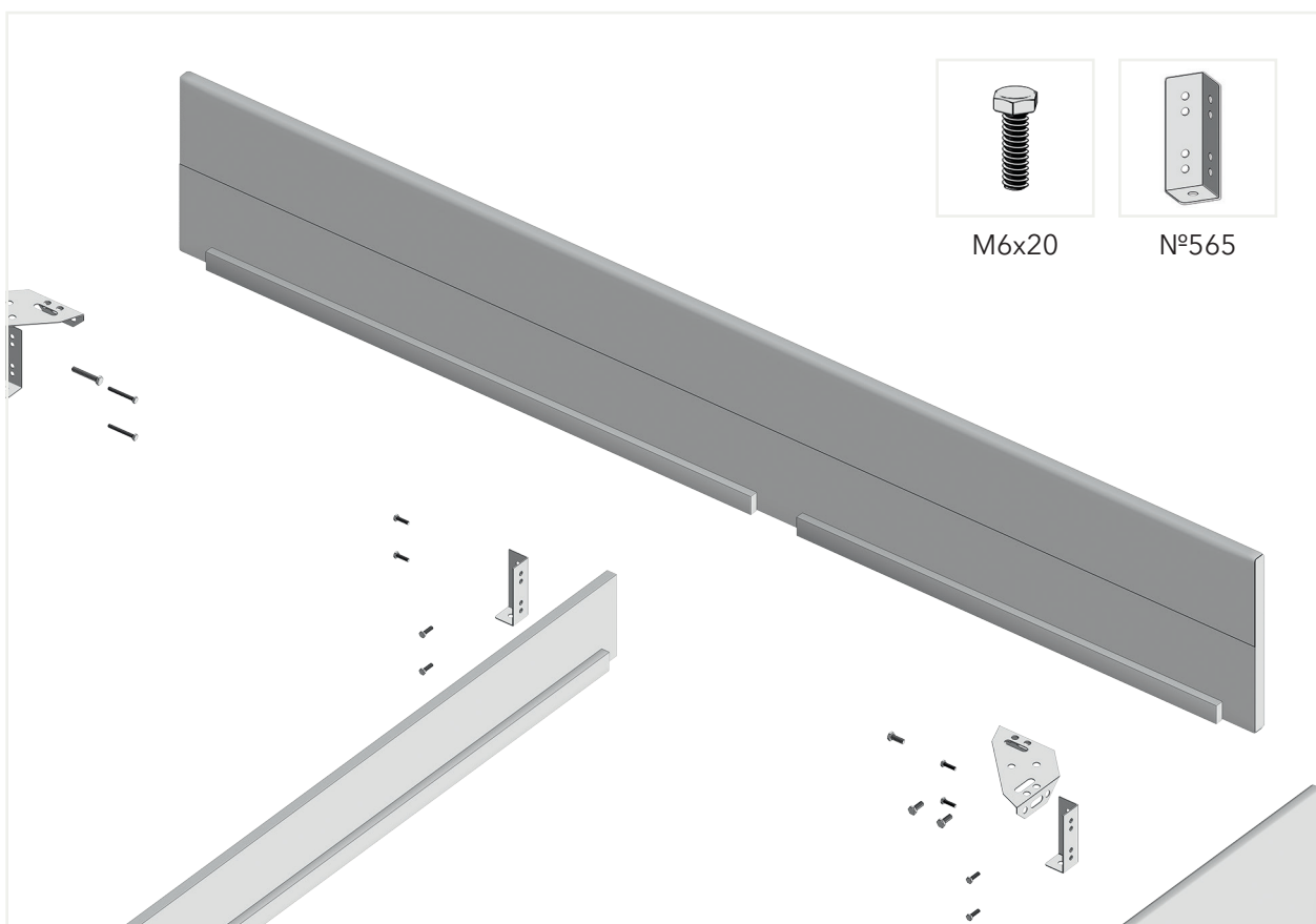
1.1.1 Соедините царги с помощью уголка №565 и болтов M6x20.
