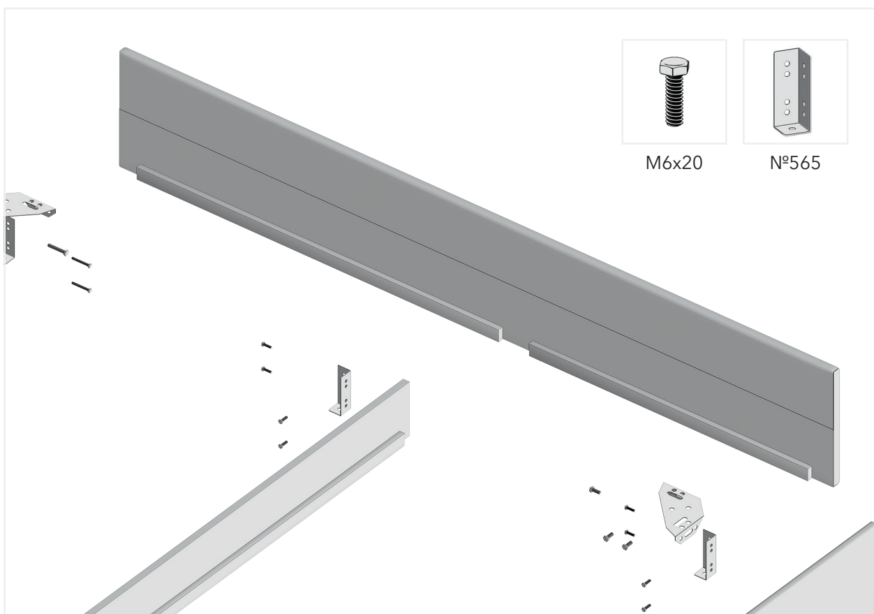
1.1.1 Соедините царги с помощью уголка №565 (2 шт) и болтов M6x20 (8 шт).
