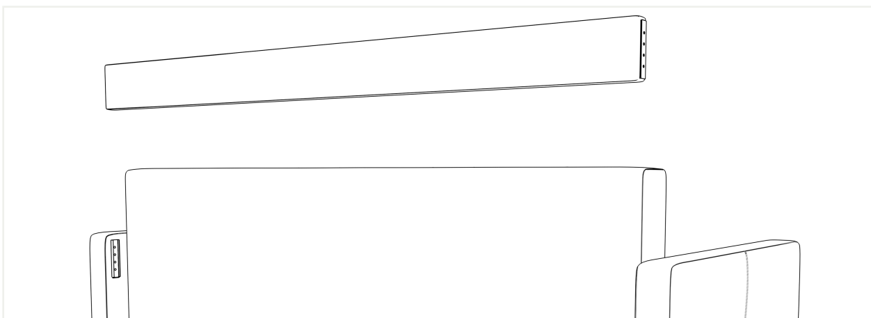
3. Закрепить заднюю планку с помощью мебельных соединителей
