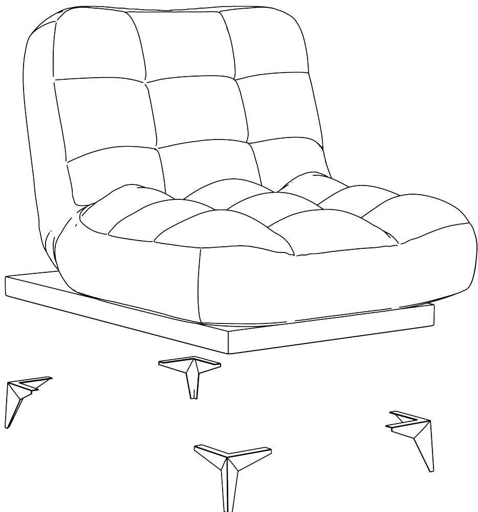
Закрепить ножки с помощью саморезов 45 мм.
