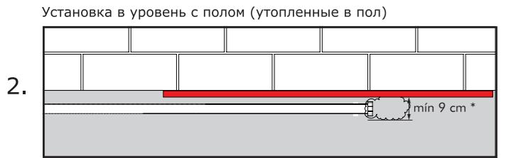
Установка в уровень с полом (утопленные в пол)
