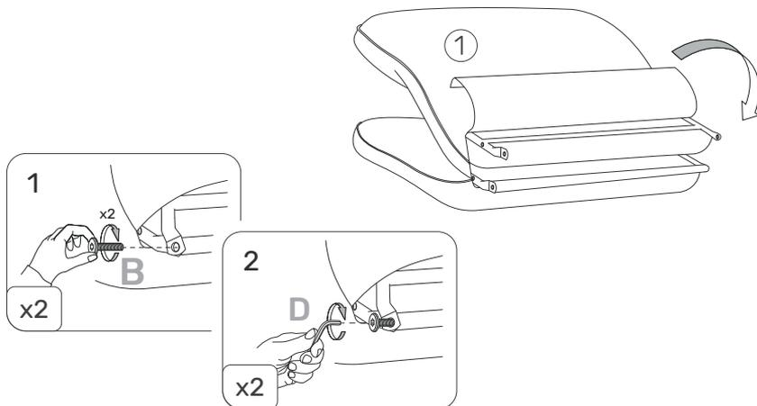
**!** Дорогие покупатели! Очень важно сначала наживить винт вручную и сделать пару оборотов, чтобы он правильно встал, и только потом затягивать шестигранником!
