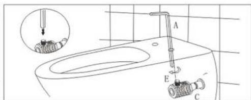
6. Зафиксируйте изделие с помощью ключа А
