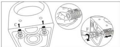
4. Установите крепление С на изделие отверстием вверх с помощью ключа F.
