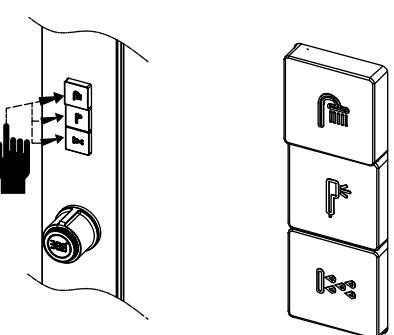
Посредством нажатий/повторных нажатий кнопок включения/выключения верхнего душа(5), ручного душа (4), гидромассажа (3) переключайте потоки воды в соответствии с Вашими предпочтениями.
