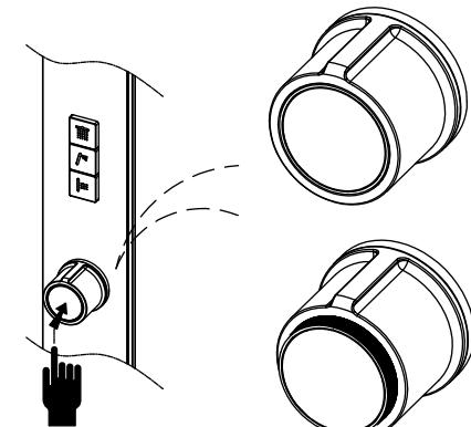
Регулировка температуры воды осуществляется вращением ручки регулировки температуры воды (2). Подача холодной воды осуществляется при повороте ручки влево (против часовой стрелки), горячей - при повороте ручки вправо (по часовой стрелке).
