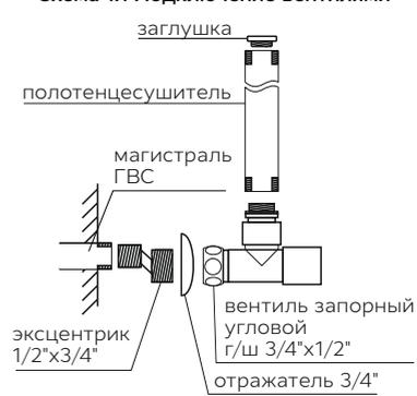
Схема 1.2 Подключение уголками
