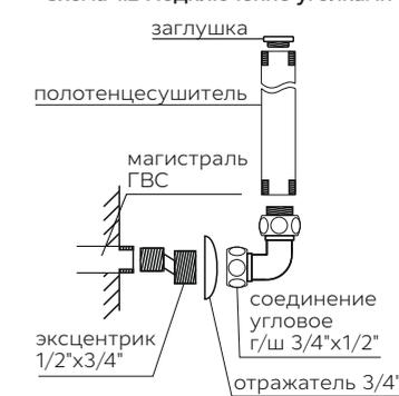
\*Заглушки входят в комплектацию полотенцесушителя и уже установлены производителем на заводе. Во избежание протечек заглушек не рекомендуется выкручивать и менять их при установке. Заглушка с воздухоотводчиком (кран Маевского) и заглушка располагаются в верхней части полотенцесушителя.
