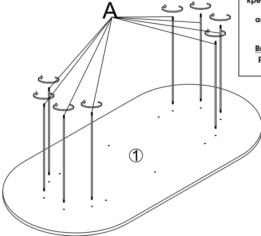
Во избежание деформации столешницы шпильками, крепление шпилек к столешнице следует производить аккуратно и без чрезмерных усилий.
