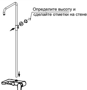
4. Прикрепите душевую стойку (поз. 1) к смесителю (поз. 3). Определите необходимую высоту крепления держателя душевой стойки (поз. 9) и сделайте отметку.
