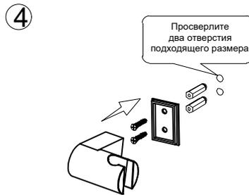
4. Закрепите держатель душа (поз. 3) на стене с помощью крепежных элементов, зафиксировав его отверткой.
