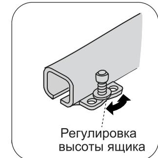
При желании, закрепите ящик к направляющим дополнительным саморезом 3x16, в комплектацию саморез не входит.
