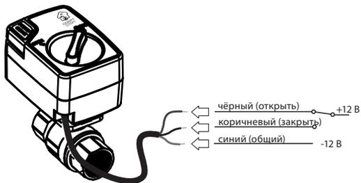
Рис. 1. Электрическая схема подключения крана с электроприводом серии СМАРТСТОП BVS 12B
