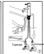
7. Подключите свободные концы шлангов (поз. 4) к угловым вентилям, затянув их гаечным ключом.
