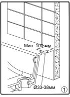
1. Сделайте отверстие в столешнице диаметром 33-38 MM.
