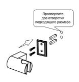
4. Закрепите держатель душа (поз. 3) на стене с помощью крепежных элементов, зафиксировав его отверткой.
