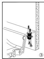
3. Проденьте крепежные элементы (поз. 3) в указанном направлении через гибкие шланги (поз. 4), затем протяните через отверстие в столешнице снизу вверх.
