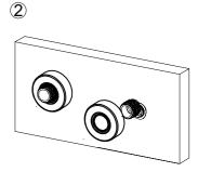
2. Прикрутите настенные отражатели (поз. 2) на эксцентрики (поз. 2).
