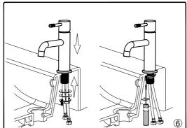
6. Закрепите фиксирующую гайку с помощью отвертки.
