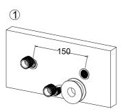
1. Обмотайте лентой резьбовые соединения эксцентриков (поз. 2) и вверните их в водопроводные выходы на стене. Затем затяните гаечным ключом. После этого промойте систему в течение 30-60 секунд, чтобы удалить возможные загрязнения
